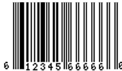
Bild 2: Von einem Standard-UPC-Generator erzeugter ‚bar-code‘, der die Zahl 1234566666 darstellt und die Orientierungs-codes jeweils als Sechser erkennen lässt.
