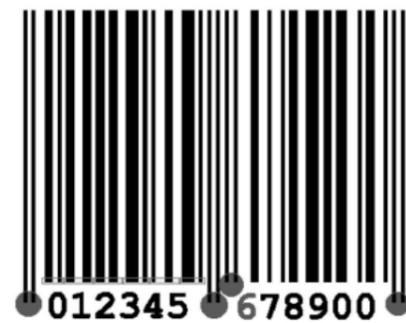
Bild 1: Die Zahlen 1-9 als ‚bar-code‘ dargestellt. Ersichtlich ist, dass die gleiche Strichkombination benutzt wird für jeden der drei Orientierungs-codes wie für die Zahl 6.
